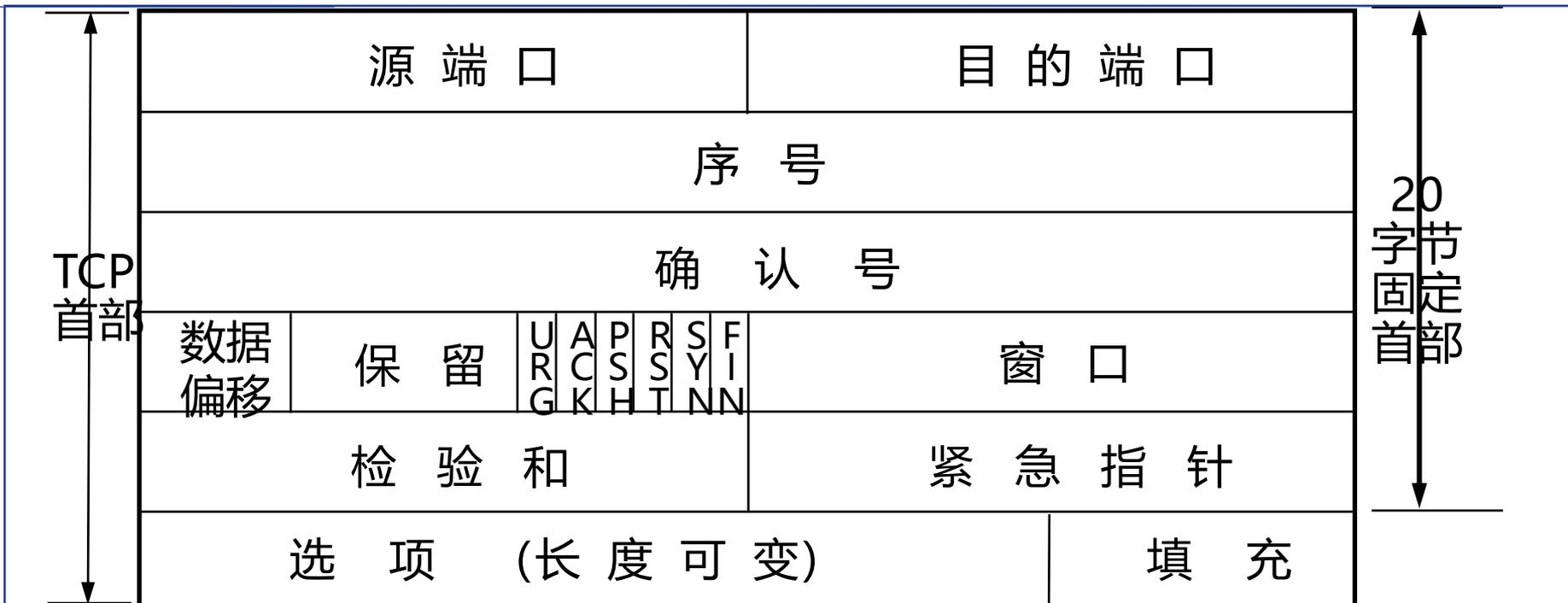
序号字段（4字节）。TCP 连接中传送的数据流中的**每一个字节**都编上一个序号。序号字段的值则指的是**本报文段所发送的数据的第一个字节**的序号。
