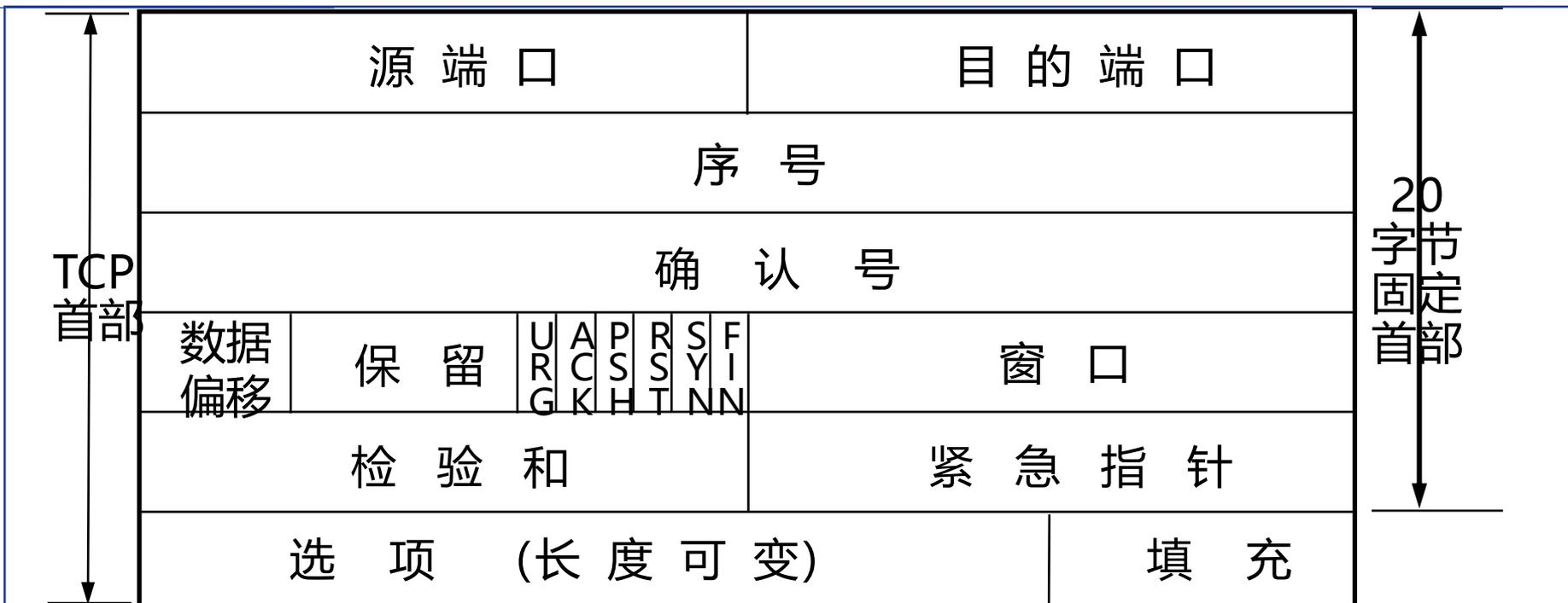
检验和（2字节）。检验和字段检验的范围包括**首部**和**数据**这两部分。在计算检验和时，要在 TCP 报文段的前面加上 12 字节的**伪首部**。
