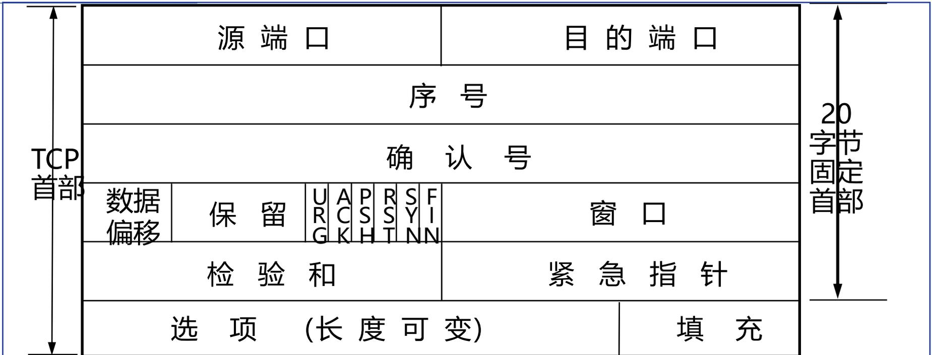
窗口字段（2字节）。窗口字段用来控制对方发送的数据量，**单位为字节**。TCP 连接的一端根据设置的缓存空间大小确定自己的接收窗口大小，然后通知对方以确定对方的发送窗口的上限。
